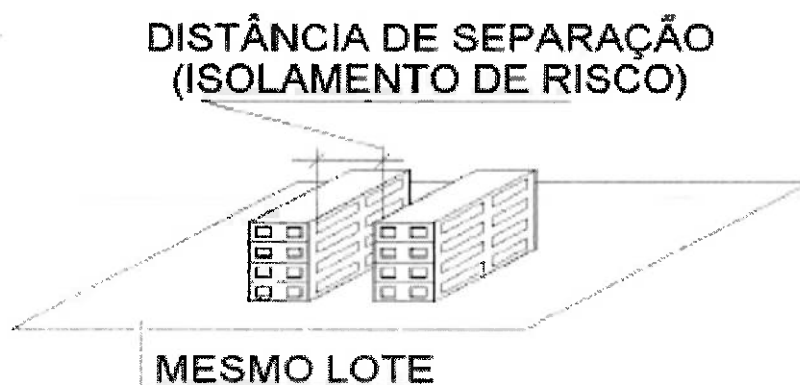
Figura 03 - Separação entre edificações no mesmo lote Fonte: IT 07 (2004) – Corpo de Bombeiros do Estado de São Paulo
