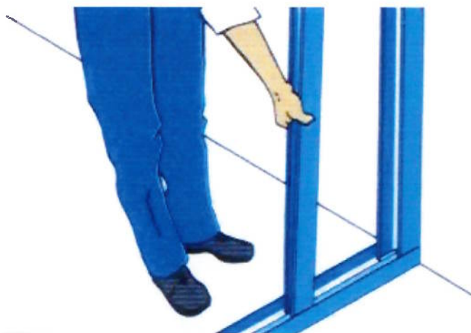
Figura 25 – Montantes são encaixados nas guias
